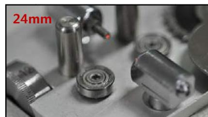
본 기능은 8. 12. 16 그리고 24mm의 tape을 단계별로 Missing Defect sensor 높이를 설정하는 기능이다.
